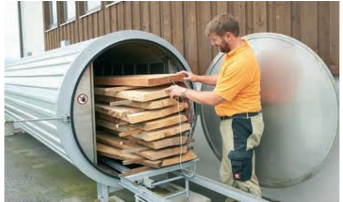
Das Massivholz wird energiesparend im Vakuum getrocknet (Foto: Möbelhaus und Schreinerei Reichenberger)
